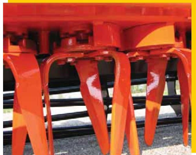
「2本爪では施工後10cmだった土塊が3本爪の施工で3~5cmになり、芋、ビート畑の播種に最適！」
